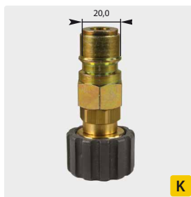
racor : rosca h. acero zincado + latón. máx. 250 bar / 150 °C
