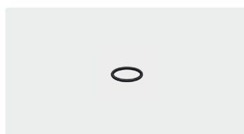
junta tórica. TYP SP-20. 13,1x2,6. máx. 150 bar / 100 °C
