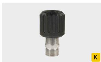
M22 h : M22 m. acero inox. máx. 400 bar / 150 °C
