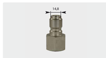
racor : rosca h. ⌀ 14,8 mm. acero zincado. máx. 150 bar / 100 °C
