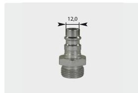
racor : rosca m. ∅ 12 mm. acero niquelado. máx. 250 bar / 100 °C
