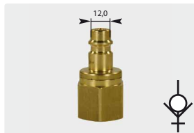
racor : rosca h. ∅ 12 mm. latón. con válvula. máx. 35 bar / 100 °C
