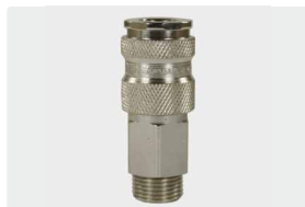
acoplador : rosca m. latón niquelado / acero niquelado. máx. 250 bar / 100 °C
