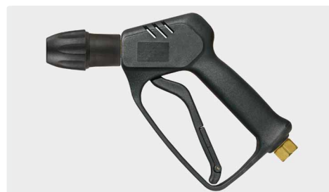
pistola profesionales ST-1100 con acoplador KW. máx. 210 bar / 25 l/min / 150 °C
