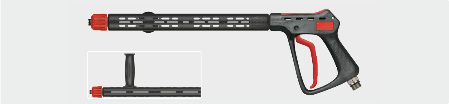
pistola profesional de altísima presión con protección rejilla ST-9 380 mm, puño y racor manual ST-740. máx. 600 bar / 80 l/min / 150 °C
