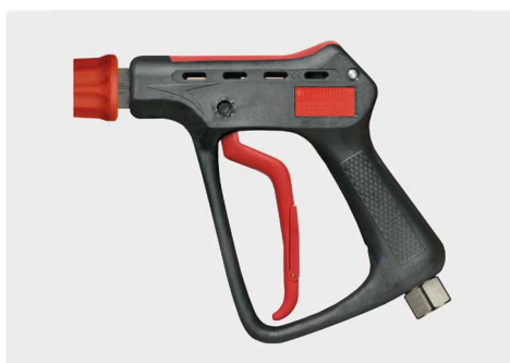
pistola profesional de altísima presión con acoplador ST-45. máx. 600 bar / 80 l/min / 150 °C
