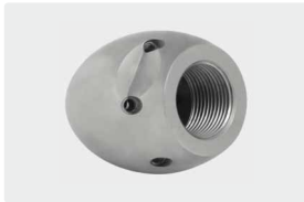
3/4" h. 6x 75° +1x 0°. 30-100 l/min. Para R 120-250 mm. exterior Ø 50 mm. 567 g.
