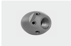
1/4" h. 6x 75° +1x 0°. 20-50 l/min. Para R 50-100 mm. Ø exterior 30 mm. 127 g.
