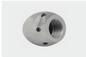
1/2" h. 6x 75° +1x 0°. 30-100 l/min. Para R 100-200 mm. Ø exterior 40 mm. 281 g.
