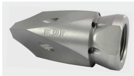
300 bar. 3/4" h. 80 mm, Ø = 38 mm, 0,29 kg. para tubos de 60 mm. insertos laterales de boquillas de acero inox. endurecido
