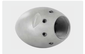
1" h. 8x 75° +1x 0°. 100-250 l/min. Para R 150-300 mm. Ø exterior 62 mm. 1.265 g.
