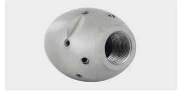
3/4" h. 6x 75° 3x 30° +1x 0°. 100-250 l/min. Para R 150-300 mm. Ø exterior 50 mm. 1.367 g.
