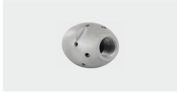
1/4" h. 6x 75° 3x 30° +1x 0°. 25-70 l/min. Para R 75-150 mm. Ø exterior 30 mm. 223 g.
