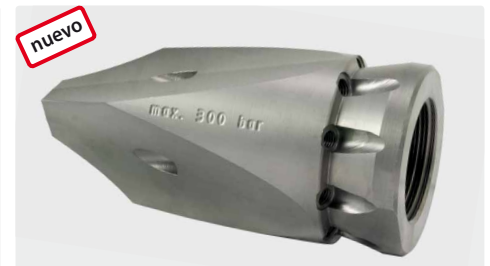
300 bar. 1" h.. 100 mm, Ø = 50 mm, 0,64 kg. para tubos de 100 mm. insertos laterales de boquillas de acero inox. endurecido
