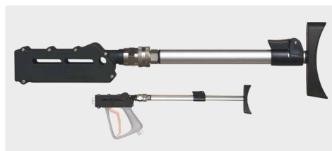
opoyo de hombro ST-3900. nuevas directrices de la Unión Europea prescriben el uso de apoyo en hombro es compatible para aplicaciones de limpieza superiores a una fuerza de reacción de operación de 150 N. para pistolas ST-3600 / ST-3500.
