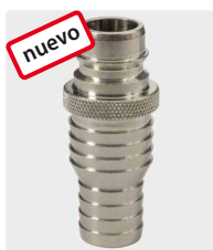
ST-45. latón nique- lado. enchufe niple para acoplar a manguera de 19-25 mm. 25 bar / 90° C
