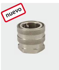
ST-45. latón nique- lado. acoplamiento rápi- do: 3/4" h. 25 bar / 90° C
