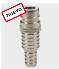
ST-45. latón nique- lado. enchufe niple para acoplar a manguera de 13-19 mm. 25 bar / 90° C
