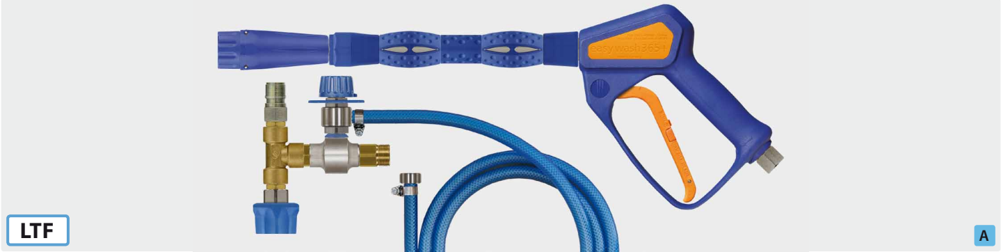
easywash365+ kit de espuma: lanza para espuma easywash365+ estándar con cabeza de espuma ST-75, inyector ST-160 (acoplador ST-45-250 latón niquelado, racor ST-45-250 acero zincado y M22 m) con válvula dosificadora ST-161, manguera de aspiración 1.000 mm y filtro de aspiración ST-32. máx. 250 bar / 90 °C
