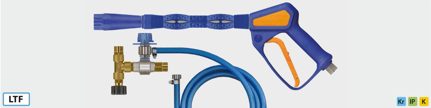
easywash365+ kit de espuma: lanza para espuma easywash365+ estándar con cabeza de espuma ST-75, inyector ST-160 (M22 h y 2 x M22 m) con válvula dosificadora ST-161, manguera de aspiración 1.000 mm y filtro de aspiración ST-32. máx. 310 bar / 90 °C
