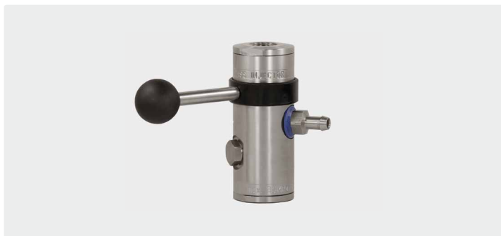
1/2" h : 1/2" h : racor 9 mm. regulador del dosificador de producto, se consige con 10 diferentes dosificadoras (0,5 - 2,0 mm). máx. 350 bar / 100 °C
