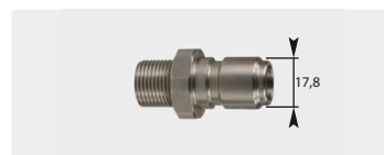
racor : rosca m. acero inox. cône 60°. máx. 250 bar / 150 °C
